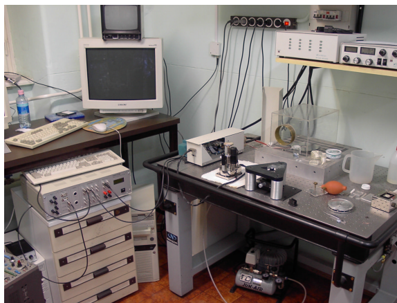
5. ábra. Atomerő-mikroszkóp képalkotását segítő DAS1414. Az új, esztétikus dobozzal szerelt DAS1414 eszközt 1 MHz-es A/D-konverter modulával bővítve keskenysávú detektorként használják.
