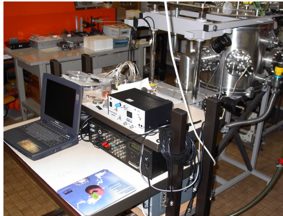
3. ábra. Impulzuslézeres vékonyréteg-építő berendezés vezérlése DAS1414 eszközzel. A készülék végzi a nagyvákuum-rendszer nyomásmérőinek kiolvasását, a nyomásszabályozó pillangószelep vezérlését, a lézer indítását, valamint a kalibrációs szakaszban a lézerenergia mérését.
