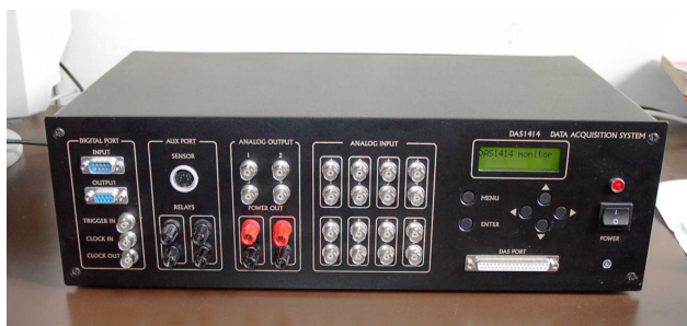
2. ábra A DAS1414 műszer felépítése és két megjelenési formája
