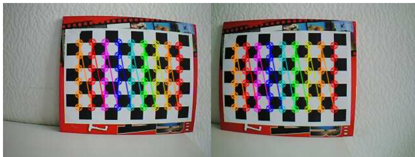
2. ábra: A robot bal és jobb kamerájával készített eredeti, legjobb minőségű, 320 \times 240 -es képek. Az OpenCV berajzolta a talált sarkokat.
