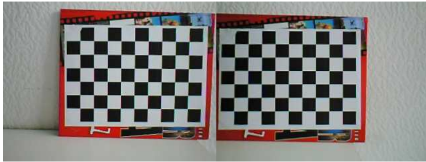
3. ábra: A kamera kalibrációja után a 2. ábrán látható képpár rektilineáris lett
