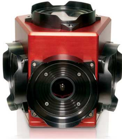
1.3. ábra. PointGrey LADYBUG5 körbelátó kamera: 30 MegaPixel felbontás, a teljes gömb 90%/t lefedő kép (Forrás: http://ww2.ptgrey.com/ld5ms/ ).
