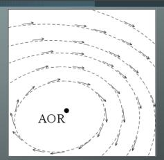
$\begin{pmatrix} v_x \\ v_y \end{pmatrix} = \frac{1}{Z} \begin{pmatrix} -f & 0 & x \\ 0 & -f & y \end{pmatrix} \begin{vmatrix} T_x \\ T_y \\ T \end{vmatrix}$
