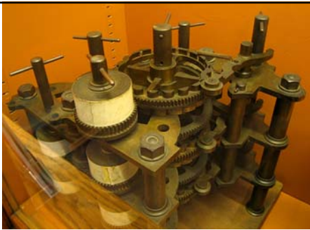
A differenciagép egy része, amit a Babbage műhelyében talált darabokból raktak össze
