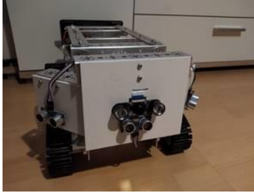
3. ábra: A kamera és a távolságszenzorok
