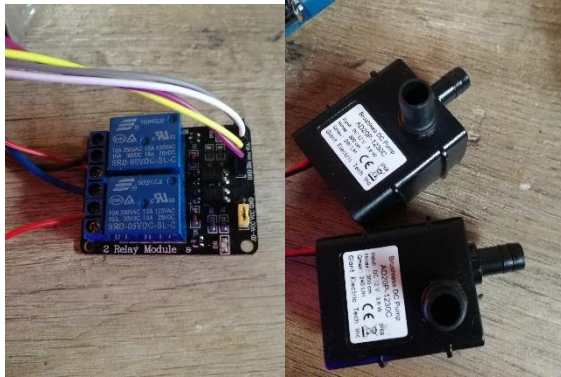
2. ábra: Relé és szivattyúk
