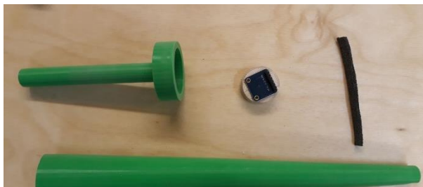
1. ábra: A pyrheliméter háza még 2 darabban és a termopile szenzor
