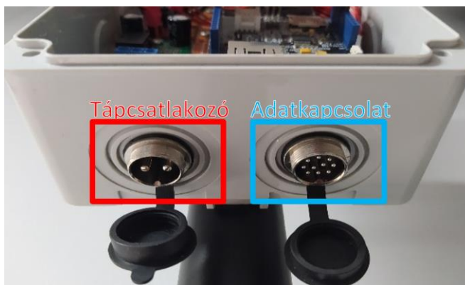
5. ábra: Hozzáférési pont csatlakozói
