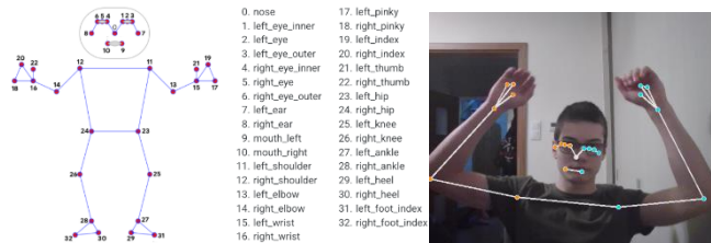
1. ábra: A Mediapipe-pal azonosítható pontok elhelyezkedése a testen és kamerakép, rajta a megállapított pontokkal
