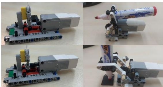
3. ábra: A két rajzeszköz felemelve és leengedve.
